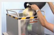
Les modèles IDEAL 4108 et 5009 sont tous deux équipés d'une large ouverture avec bande de transport qui permet d'alimenter de façon continu le destructeur avec des liasses de papier volumineuses ou des papiers froissés. Le modèle 5009 peut même détruire des classeurs complets, mécanisme inclus !
