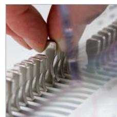
Les poinçons débrayables individuellement permettent de moduler le nombre de trous à perforer en fonction de la reliure à réaliser.
