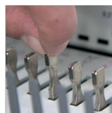
Poinçons débrayables individuellement pour de moduler le nombre de trous à perforer.
