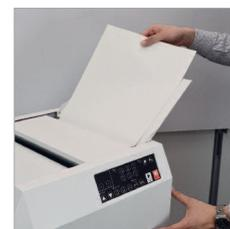
Alimentation manuelle des liasses et déclenchement automatique de l'agrafage-pliage.
