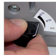
Marge de perforation réglable (ci-dessus) et poinçons débrayables individuellement (ci-dessous) sur le modèle Combi S.
